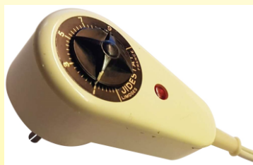
约1972年。在利摩日由Jidé制造的品牌为Jidéstat的电源控制箱。是所有系统中最成功的。尺寸非常小，它是可调节的，并且是合并到电插头里。这是唯一一款带一个速动磁铁触点的型号。直到现在的这个年代，它才被机电系统所超越。（Ultimheat收集）。
