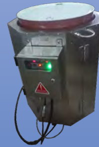
坚固的笼罩式烤箱，用于通过红外线快速加热桶
