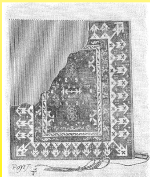
加热垫的内部视图，左上方 - 电线是通过电流穿过的，右下方 - 电源插座（1904，La Nature, Ultimheat 收藏）
