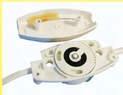
在加热毯上的 3 档位加热开关和两档位停止开关。在旋转系统和滑动系统之间的中等型号（约 1970 年，Gitem Ultimheat 收集）
