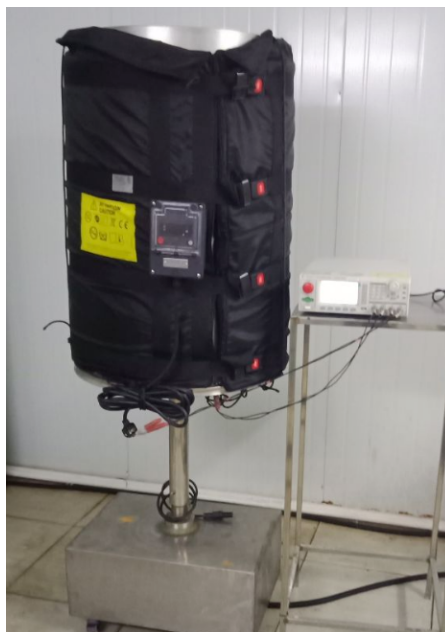
IPx6 测试后的绝缘电阻测量
