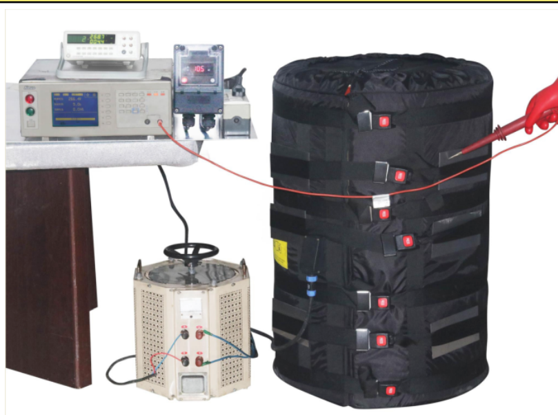
在热条件下总电流泄漏的测量设备
