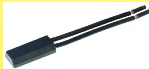
2019 年用于加热变压器的快速闭合的温度限制器，提取自 1966 年 Texas 仪器 7AM 型号，适用于 230V，塑料防水外壳。温度范围是 5 到 8°C。型号 V7AM。(Ultimheat 收集)
